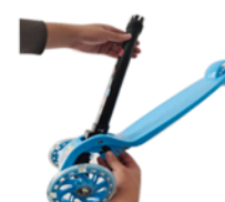
b) Pressione e segure o botão com uma das mãos e, com a outra, levante a haste do patinete.
