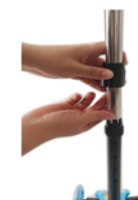
c) Alinhe o guidão com a haste e pressione o botão para instalá-lo, empurrando o botão para baixo.
