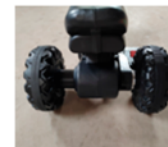
b) Instale as rodas, posicionando uma em cada lado com o lado plano voltado para fora.
