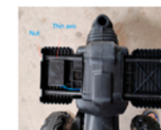
d) Passe dois eixos finos dentro do apoio para os pés e aperte as extremidades com porcas.
