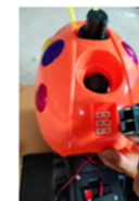
g) Instale a parte frontal, alinhe o conector do interruptor com o encaixe e insira corretamente.
