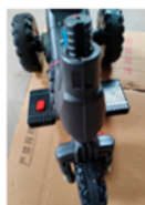
e) Instale a suspensão dianteira (ou garfo dianteiro).
